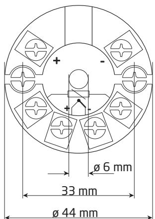
**Монтаж кабеля датчика**
